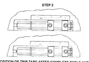
POSITION OF TRIP TABS AFTER COMPLETE CYCLE AND WITH 1/16" OVERRIDE
